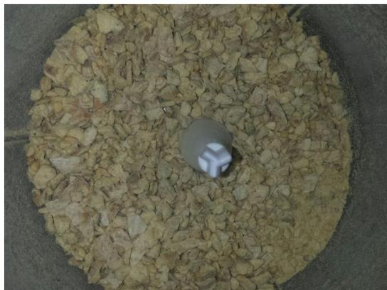
Figura 22. Molienda de las rodajas deshidratadas de guayaba
