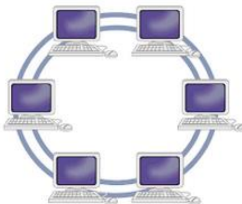
Figura 13: Topología en Anillo Doble
