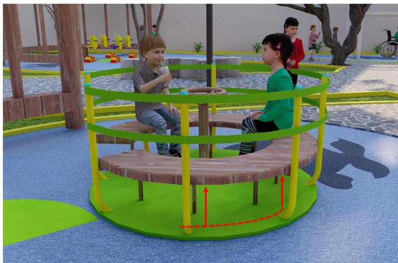
El diseño muestra una altura de 30cm desde la superficie de la rotonda a la base superior del asiento de MDF.
