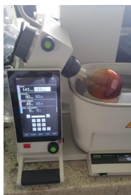
Figura 12. Evaporación del solvente para concentrar la oleorresina de cúrcuma.
