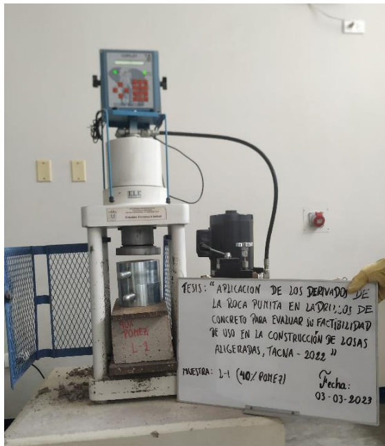
Rotura del Ladrillo de Concreto a los 28 días – 40 % pómez
