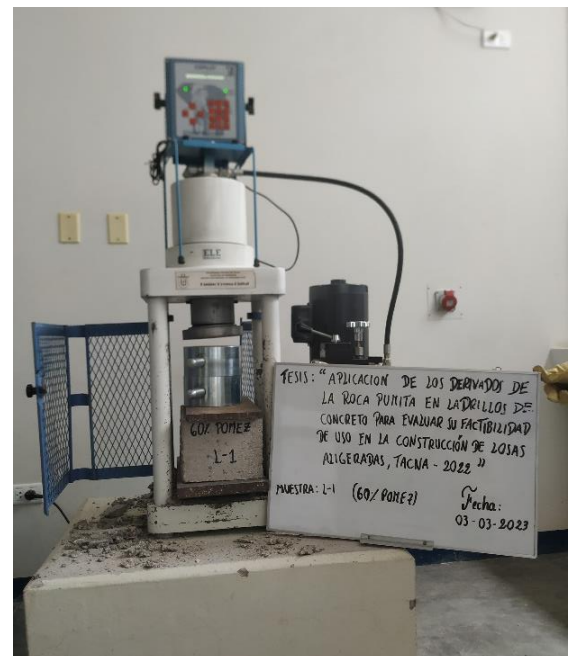
Rotura del Ladrillo de Concreto a los 28 días – 60 % pómez
