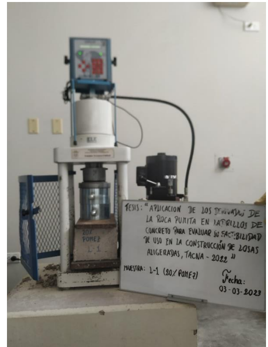
Rotura del Ladrillo de Concreto a los 28 días – 20% pómez
