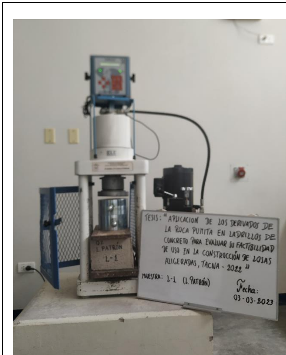
Rotura del Ladrillo de Concreto a los 28 días – Patrón
